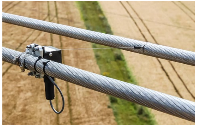
PT1-Sensor für Teilfeldschwingungsmessung
