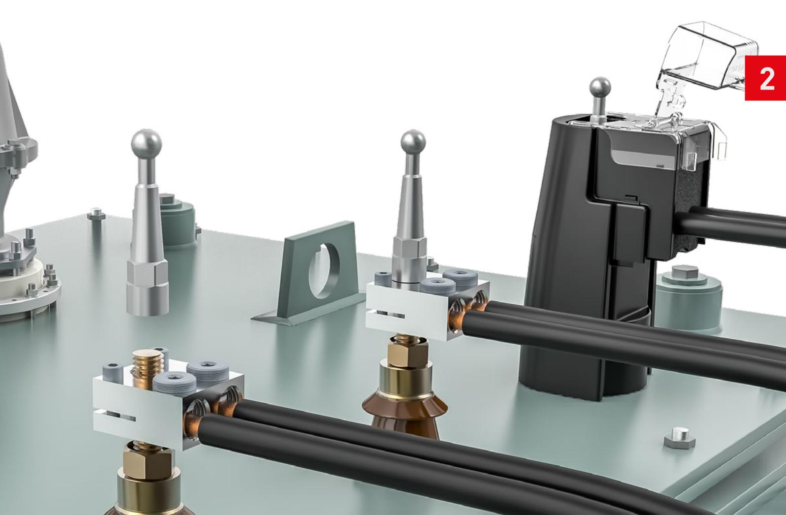
Bei der Anwendung von flachen 2DIREKT Klemmen in Kombination mit einer Abdeckhaube muss die Erdung direkt über die Trafokerze erfolgen. Dabei ist nur ein horizontaler Leiterabgang möglich.
