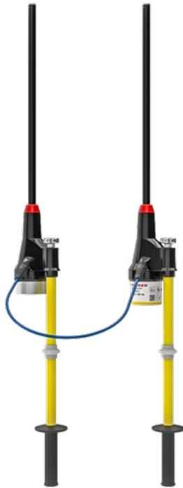
Das Deltameter 5 ist ein Messgerät zur Anzeige der Spannungsdifferenz zwischen zwei Phasen in **Mittelspannungsnetzen**. Es zeigt die Spannungsdifferenz zwischen zwei Phasen quantitativ über eine vierstellige Segmentanzeige mit einer Auflösung von 10 V an. Damit bietet das Deltameter 5 eine sehr präzise Entscheidungshilfe über die anstehenden Schaltvorgänge.
