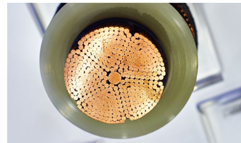
Conexionado con FrontCon: El esmalte no debe ser retirado de los alambres individuales.
