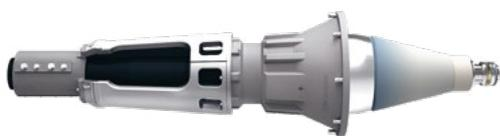
Le système embrochable est éprouvé pour tous les câbles XLPE, cuivre comme aluminium avec des sections pouvant atteindre 3,000 mm<sup>2</sup> dans la version THT. Un collier intégré absorbe les charges mécaniques du câble et facilite l'installation des câbles.
