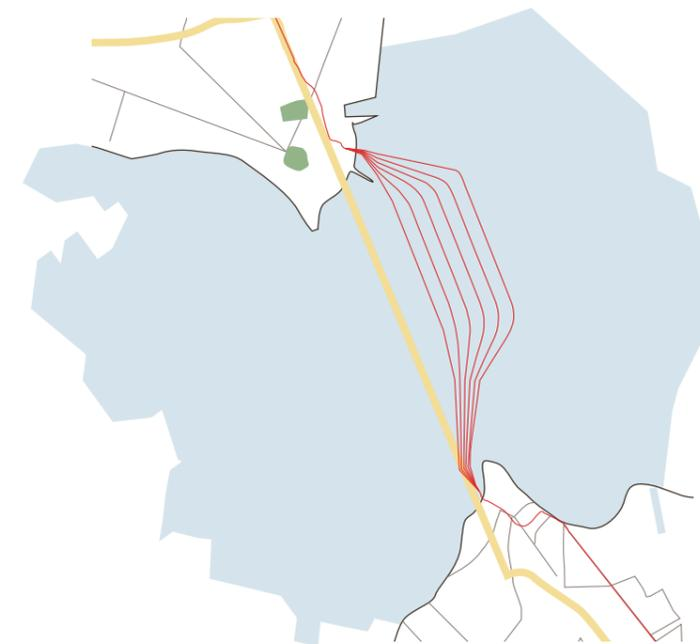
Zwei jeweils dreiphasige EHV-Seekabel werden an beiden Ufern durch Verbindungsmuffen von PFISTERER an die Landkabel angeschlossen.
