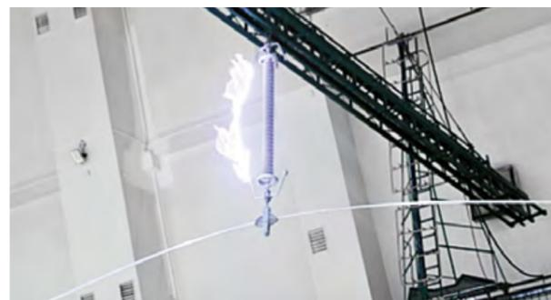
Die elektrische Auslegung der Isolatoren und Schutzarmaturen für RTE unterstützte PFISTERER mit Berechnungen der elektrischen Feldstärken mithilfe moderner Simulationssoftware (Abbildungen Seite 9 oben). „Die Berechnungen bestätigen in Verbindung mit Erfahrungswerten, ob ein Kettendesign aus Sicht des Koronaszutzes geeignet oder noch weiter anzupassen ist. Das beschleunigt den Auslegungsprozess und gibt Sicherheit bei den daran anschließenden dielektrischen Prüfun-
