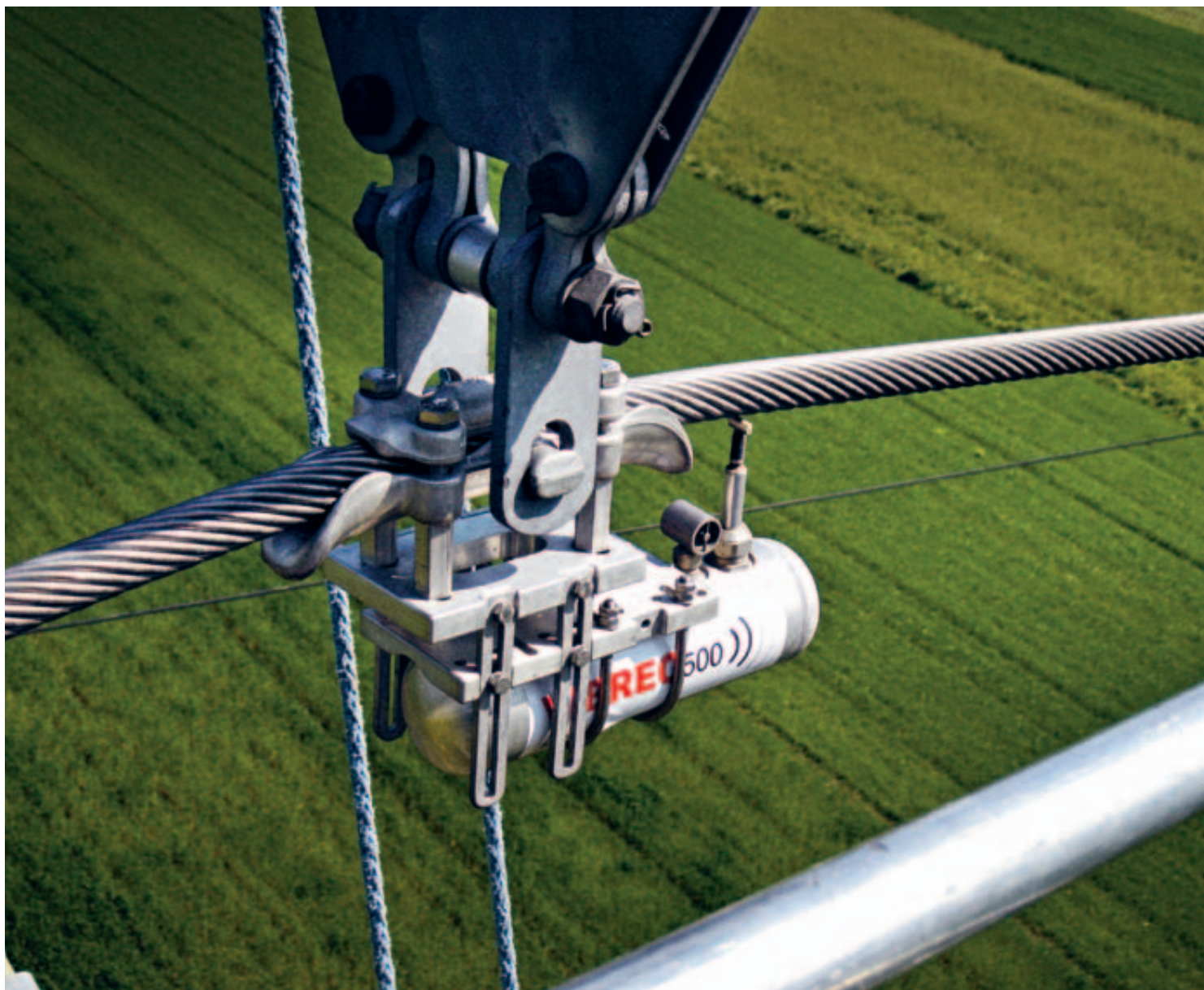
Instrumente für Leiterseilschwingungsmessungen, die nicht nur Schwingungsamplituden und -frequenzen, sondern auch die wichtigen Einflussfaktoren Windgeschwindigkeit und Umgebungstemperatur messen, stellt bislang nur PFISTERER her. Hier ein Schwingungsrekorder vom Typ VIBREC500WT für Messungen an Einzelleitern im Einsatz an einer 110-kV-Leitung der Wiener Netze.
