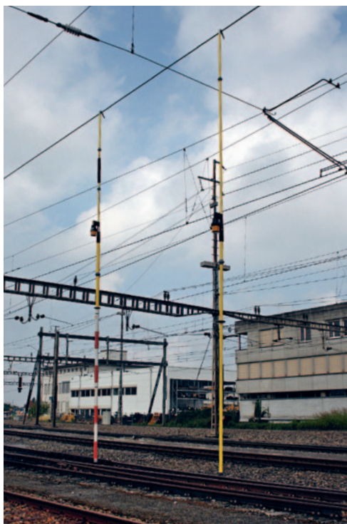
Schlechte Sicht, laute Umgebungsgeräusche? Für den Bahn-Spannungsprüfer KP-Test 5R kein Problem: Seine optischen und akustischen Signale sind für stets eindeutige Messergebnisse optimal ausgelegt (Bild oben).
