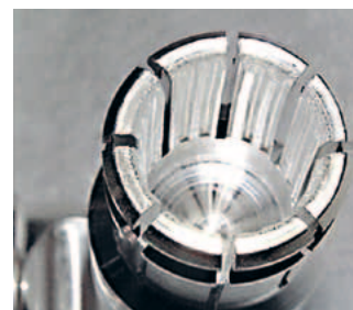
Bild 4: Auch bei der Konstruktion von Steckverbindern werden für eine jahrzehntelange Lebensdauer der Verbindung die Kontaktstellen als Kontaktlinien definiert sowie eine hohe Elastizität mittels Federung eingebracht.
