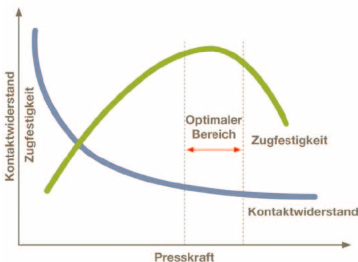
Bild 3: Designkriterien der Presstechnik stimmen elektrische und mechanische Anforderungen aufeinander ab: Die Kontaktkraft muss beim Verpressen so gewählt sein, dass der Kontaktwiderstand möglichst reduziert wird und gleichzeitig die höchstmögliche Zugfestigkeit der Verbindung erhalten bleibt.
