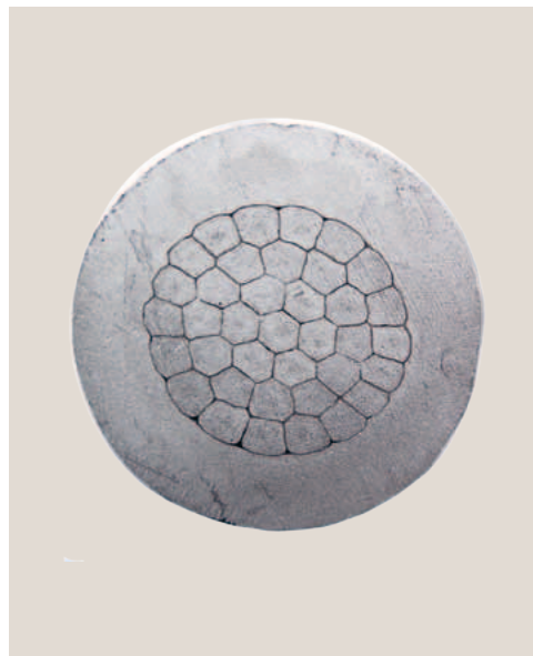
Bild 2: Eine zuverlässige Langzeitkontaktierung erfordert die optimale Querleitfähigkeit des Leiters. Hierfür müssen beim Einsatz der Presstechnik nicht nur die Außenlagen des Leiterverbundes verpresst werden, sondern auch seine Innenlagen. Eine optimale Verpressung per symmetrischem Press-Verfahren zeigt dieses Bild: Alle Einzeldrähte weisen die hierfür charakteristische kantige Verformung auf.
