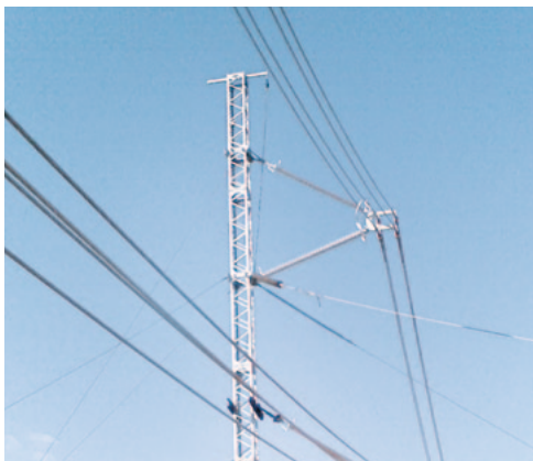
Testaufbau der 420-kV-Isoliertraverse für die Niederlande
