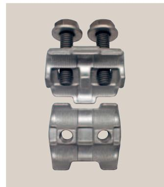
**Bild 1: Ideale Anordnung der Kontaktelemente:** Die Regel von Donati zur Strom-Kommuntierung zeigt, dass die Stromdichte einer Verbindung nicht an allen Stellen gleich ist: Die Kommuntierung erfolgt zum großen Teil am Beginn und am Ende der Überlappungsfläche der Leiter. Ergo: Die Kontaktbereiche (Zonen, Linien, Punkte) werden möglichst nah an den Anfang bzw. das Ende der Klemme platziert.
