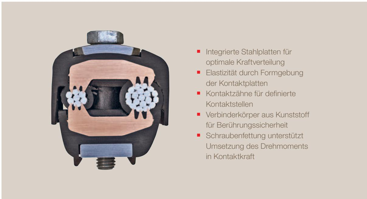
**Bild 3:** Bereits bei der ISO-Abzweigklemme aus den 1960er Jahren wurden die Designkriterien moderner Klemmen berücksichtigt.
