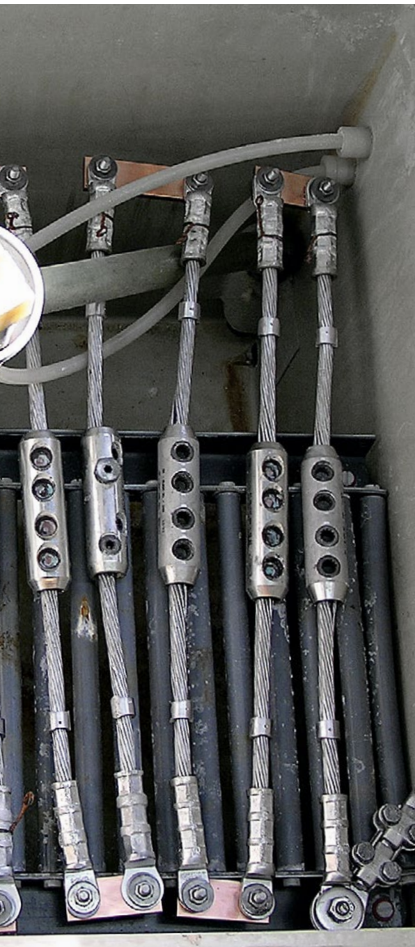
Bild 7: Salzbeständigkeitsprüfung nach IEC 60068-2-52: Die Prüflinge (Zustand vor der zyklischen Salznebelbelastung) werden in einer Prüfkammer mit 3 m 3 Volumen angeordnet und darin mit einer Salzwasserlösung (5 % NaCl) besprüht. Ein Testzyklus dauert 24 Stunden (2 h Sprühen, 22 h Trocknen), währenddessen stehen die Prüflinge unter zyklischer Wechselstrombelastung ( I_{on} = 220 \text{ A} /für 1 h, I_{off} = 0 \text{ A} /für 2 h).
