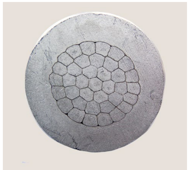
Bild 2: Eine zuverlässige Langzeitkontaktierung erfordert die optimale Querleitfähigkeit des Leiters. Hierfür müssen beim Einsatz der Presstechnik nicht nur die Außenlagen des Leiterverbundes verpresst werden sondern auch seine Innenlagen. Eine optimale Verpressung per symmetrischem Press-Verfahren zeigt dieses Bild: Alle Einzeldrähte weisen die hierfür charakteristische kantige Verformung auf.
