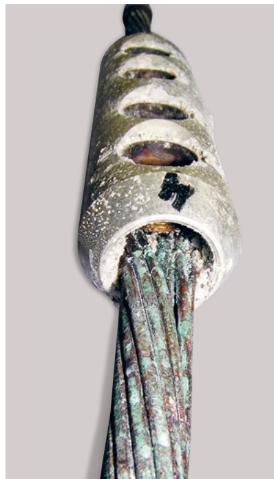
Bild 8: Leiter und Verbinder nach zehn Wochen Salzbeständigkeitsprüfung gemäß IEC 60068-2-52
