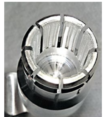
Bild 4: Auch bei der Konstruktion von Steckverbindern werden für eine jahrzehntelange Lebensdauer der Verbindung die Kontaktstellen als Kontaktlinien definiert sowie eine hohe Elastizität mittels Federung eingebracht.
