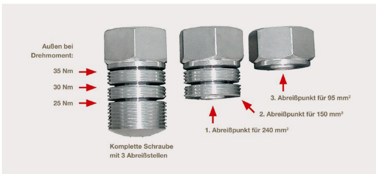
Bild 6: Nachteil von Abreißschrauben mit mehrfach gestuften Abreißstellen: Das größte definierte Drehmoment (35 Nm) muss konstruktiv bedingt an der 3. Abreißstelle wirken, das kleinste definierte Drehmoment (25 Nm) an der 1. Abreißstelle. Aufgrund der drehmomentgesteuerten Krafteinleitung wirkt somit auf die kleinsten Leiter (bis 95 mm 2 ) eine größere Kontaktkraft, während die größten Leiter (bis 240 mm 2 ) mit einer geringeren Kontaktkraft kontaktiert werden.
