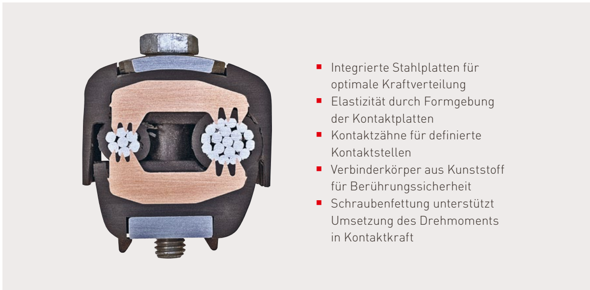
Bild 3: Bereits bei der ISO-Abzweigungsklemme aus den 1960er Jahren wurden die Designkriterien moderner Klemmen berücksichtigt.
