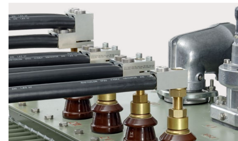
La borne 2DIREKT se raccorde directement au transformateur de distribution : aucune languette, cosse de câble ou douille ni aucun écrou n'est requis.
