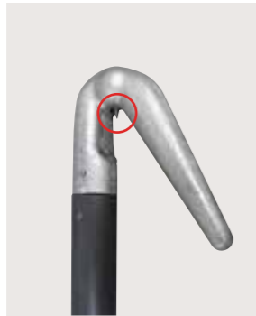
Bild 5: Kontakt mit Köpfchen: Um umständliches oder unzureichendes Kontaktieren zu vermeiden, besitzen PFISTERER Spannungsprüfer für AC- oder DC-Oberleitungen eine robuste Hakenelektrode. Sie wird am Fahrdraht eingehängt. Für optimale Kontaktierung dringt dabei ihre Spitze (rot umkreist) in den Fahrdraht ein. Durch das Einhängen baut das Eigengewicht des Spannungsprüfers konstanten Kontaktdruck auf.
