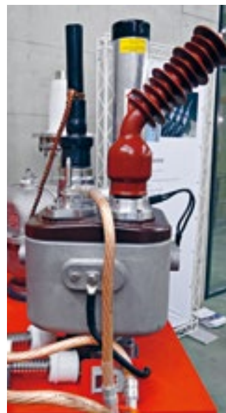
Maximal flexibel: An das neue MV-CONNEX-Transformatoren-Anschlussstück können neben Mittelspannungskabeln weitere CONNEX-Komponenten einfach per Stecktechnik angeschlossen werden, zum Beispiel, wie hier zu sehen, ein Überspannungsableiter (hinten rechts) für optimalen Schutz direkt an der Anlage, ein Prüf- und Übergangsschlussstück (vorn rechts) oder auch eine Erdungsgarnitur (vorn links).
